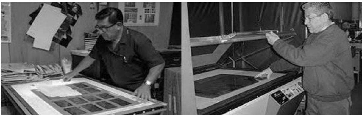
El proceso minucioso que se llevaba en Fotomecánica, antes de realizar la placa que se utilizaría en la Prensa. Este proceso era llamado Pre-prensa.
