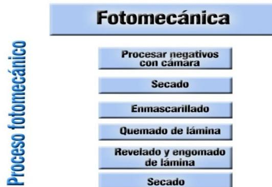
*Diagrama del proceso de Fotomecánica de la producción manual del Offset.
